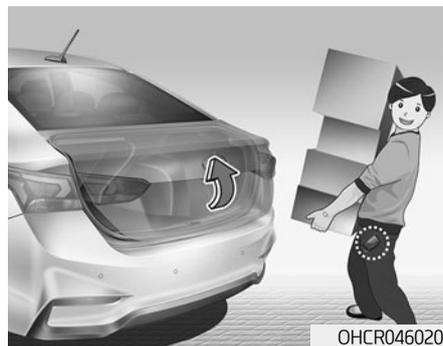
На автомобиле, оснащённом электронным ключом, багажник можно открыть без прикосновений с помощью системы автоматического открытия багажника.
