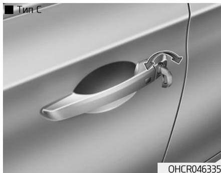
Необходимо повернуть ключ в сторону задней части автомобиля для разблокирования и в сторону передней части автомобиля для блокирования замка двери.
