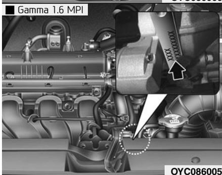
Серийный номер двигателя выштампован на блоке цилиндров, как показано на рисунке.
