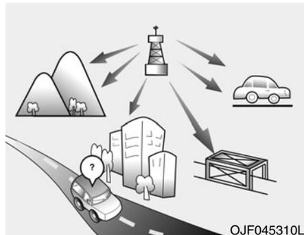
Радиосигнал диапазона FM передается на высоких частотах и не искривляется, проходя вдоль поверхности Земли. Поэтому, как правило, мощность таких радиосигналов начинает падать даже на небольшом расстоянии от передающей радиостанции. Кроме того, на их распространение оказывают влияние здания, рельеф местности или другие препятствия. В результате в конкретных условиях приема радиосигнала может создаться впечатление о неисправности
