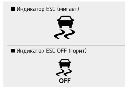
Если система ESC работает нормально, то при переводе выключателя зажигания в положение ОП индикатор ESC загорается и через некоторое время гаснет.
