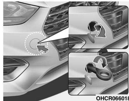
2. Снимите крышку с отверстия в бампере, нажав на нижнюю часть крышки.
