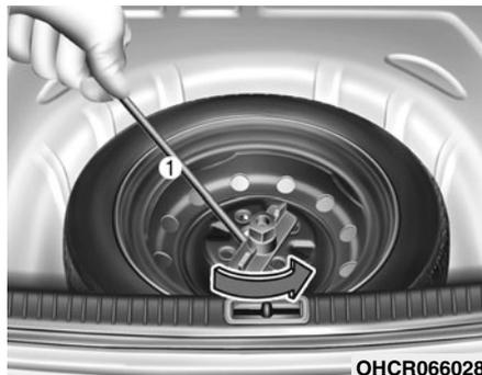
Если сложно вывернуть прижимной барашковый болт колеса вручную, его можно легко вывернуть, используя ручку домкрата.
