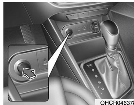
Для использования прикуривателя выключатель зажигания должен быть установлен в положение АСС или ОП.
