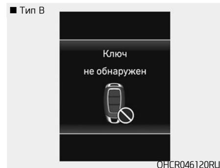
Это предупреждающее сообщение отображается, когда при нажатии кнопки пуска/остановки двигателя электронного ключа нет внутри автомобиля или он не обнаружен системой. Индикатор иммобилайзера также горит.
