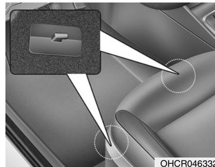
Передние коврики пола ВСЕГДА должны быть прикреплены к автомобилю с помощью специальных фиксаторов. Фиксаторами на ковре переднего пола коврики удерживаются от смещения вперед.
