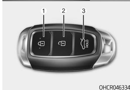
Для блокирования дверей используется кнопка на наружной ручке двери (при этом необходимо иметь при себе электронный ключ) или кнопка блокирования дверей (1) на электронном ключе.
