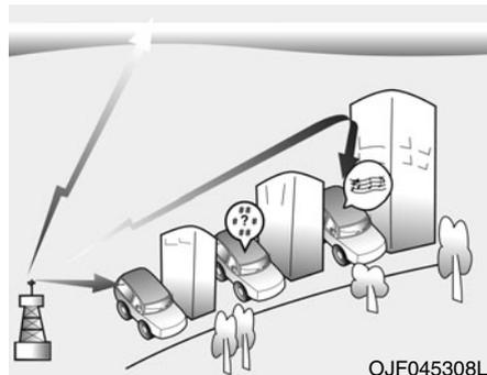
AM и FM радиосигналы передаются с высотных радиопередатчиков, расположенных вокруг города. Они улавливаются радиоантенной вашего автомобиля. Затем этот сигнал передается радиоприемником в динамики автомобиля.
