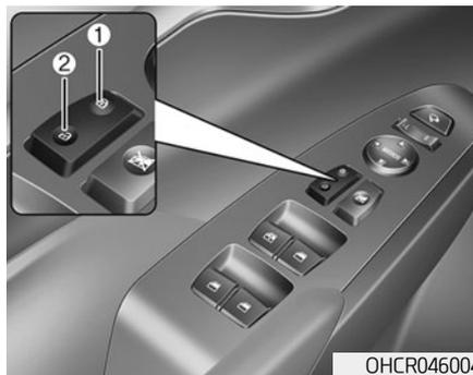
При нажатии на часть (1) переключателя производится блокирование всех дверей.
