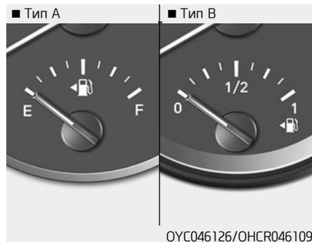
Этот указатель отображает примерное количество топлива в топливном баке.
