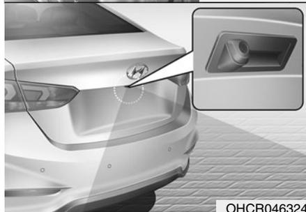
Камера заднего вида включается при работающем двигателе и переводе рычага переключения передач в положение R (задний ход).
