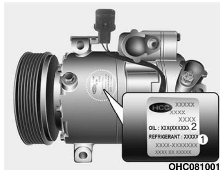
На этикетке компрессора указаны модель, номер по каталогу поставщика и серийный номер компрессора, тип хладагента (1) и тип компрессорного масла (2).
