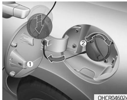
3. Потяните крышку люка топливозаливной горловины (1) до полного открывания.
