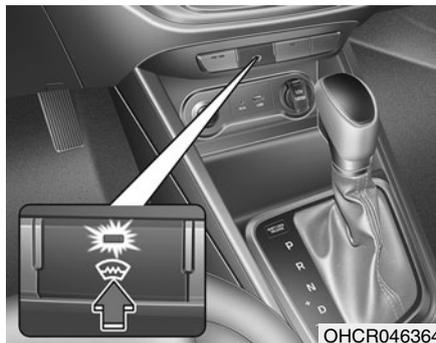
При работающем двигателе обогреватель нагревает ветровое стекло изнутри и снаружи для устранения инея, запотевания и ледяного налета.
