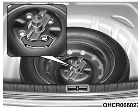
Вращайте барашковый прижимной болт против часовой стрелки для снятия запасного колеса.
