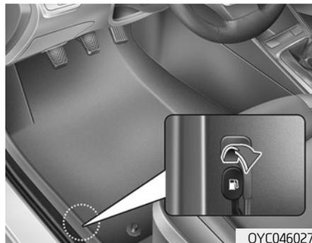
Крышка люка топливозаливной горловины открывается ручкой изнутри автомобиля.
