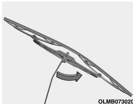
1. Поднимите рычаг стеклоочистителя и поверните узел щетки, чтобы получить доступ к защелке.
