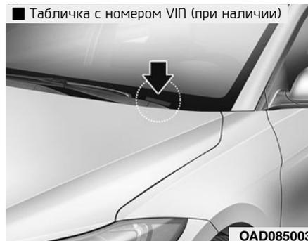
Кроме того, номер VIN указан на пластинке, которая прикреплена к верхней части приборной панели. Номер, нанесенный на пластинку, виден снаружи через ветровое стекло.
