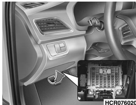
Под крышкой панели плавких предохранителей и реле находится табличка с наименованиями предохранителей/реле и величинами их номинальных токов.
