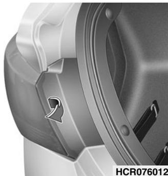
4. Демонтируйте узел заднего комбинированного фонаря с кузова автомобиля.
