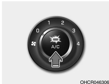
Для включения системы кондиционирования нажмите кнопку A/C (при этом загорится расположенный в ней индикатор). Повторное нажатие на эту кнопку приводит к выключению системы кондиционирования.
