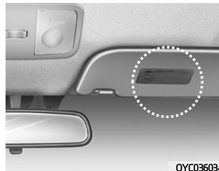
Предупреждающие наклейки прикрепляются к модулям подушек безопасности для того, чтобы уведомить водителя и пассажиров об опасности, связанной с системой подушек безопасности.
