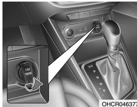
Электрическая розетка предназначена для питания мобильных телефонов или иных устройств, предназначенных для работы в электрической системе автомобиля. Устройства не должны потреблять более 180 Вт при работе двигателя.
