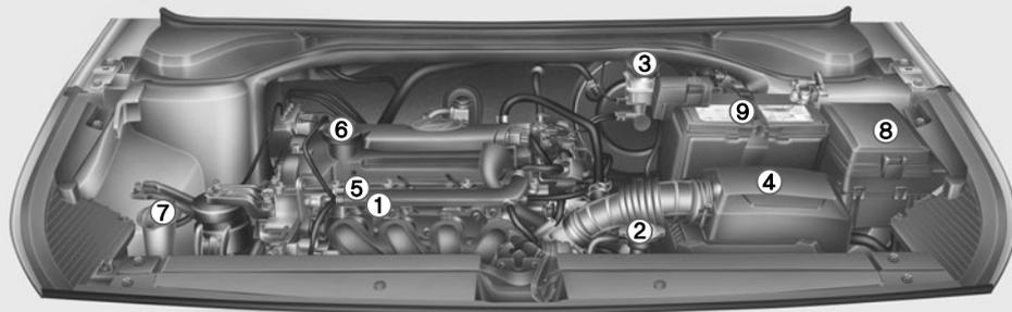
1. Расширительный бачок для охлаждающей жидкости двигателя
