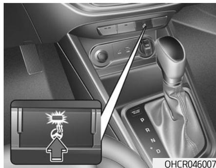
Обогрев рулевого колеса включается нажатием кнопки при включенном зажигании или при работающем двигателе. На кнопке загорится индикатор.
