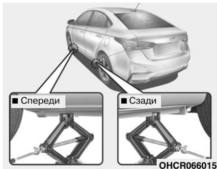
7. Установите домкрат под специально предназначенную точку подъема, ближайшую к подлежащему замене колесу. Точки подъема — это приваренные к раме пластины с двумя упорами и выступом. Запрещается производить подъем автомобиля домкратом в каком-либо другом месте. При этом может быть поврежден боковой уплотнительный молдинг.
