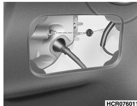
3. Ослабьте гайки крепления узла.
