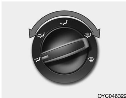
Ручка выбора режима распределения воздуха предназначена для управления потоком воздуха в системе вентиляции.
