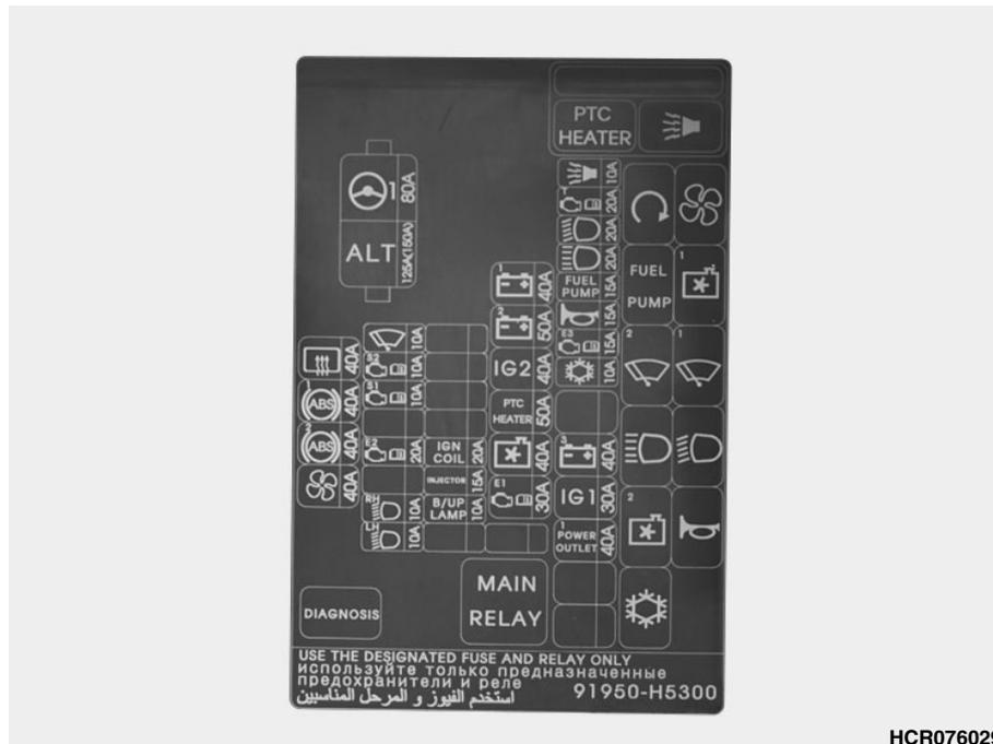
проверке блока предохранителей следует использовать табличку, нанесенную на крышку блока предохранителей.
