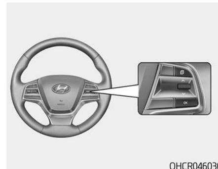
Для изменения режима суточного пробега нажмите переключатель « $\wedge$ ,  $\vee$ » на рулевом колесе.
