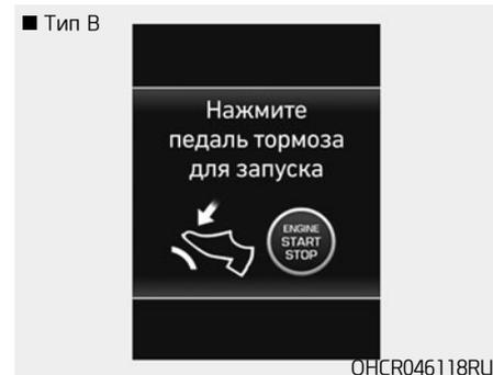
Это предупреждающее сообщение отображается, если кнопка пуска/остановки двигателя нажата в положение АСС дважды без нажатия педали тормоза.
