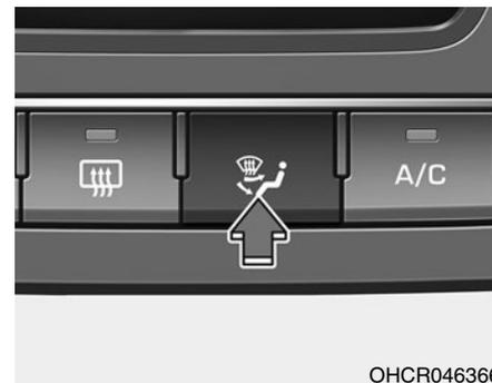
Кнопка выбора режима распределения воздуха управляет направлением потоков воздуха через систему вентиляции.
