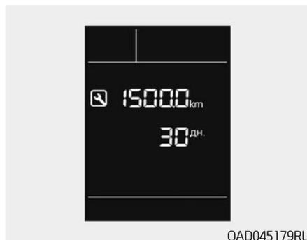
Когда остаточный пробег или время достигает 1500 км (900 миль) или 30 дней, при каждом переводе выключателя зажигания или кнопки пуска/остановки двигателя в положение ОП символ технического обслуживания (🔧) мигает в течение нескольких секунд.
