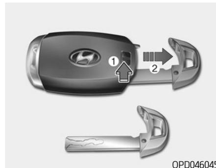
Нажмите и удерживайте кнопку (1), затем извлеките механический ключ (2). Вставьте механический ключ в отверстие для ключа в дверном замке.
