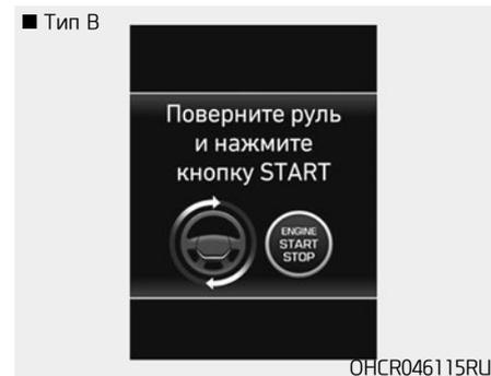
Это предупреждающее сообщение отображается, когда рулевое колесо не разблокировано обычным способом при нажатии кнопки пуска/остановки двигателя.
