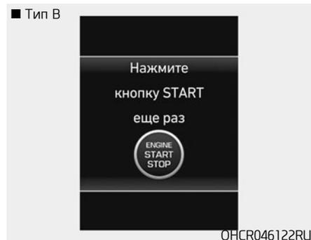
Это предупреждающее сообщение отображается в случае невозможности пуска двигателя нажатием кнопки пуска/остановки двигателя.
