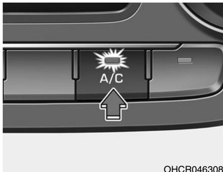
Для включения системы кондиционирования нажмите кнопку A/C (при этом загорится расположенный в ней индикатор).
