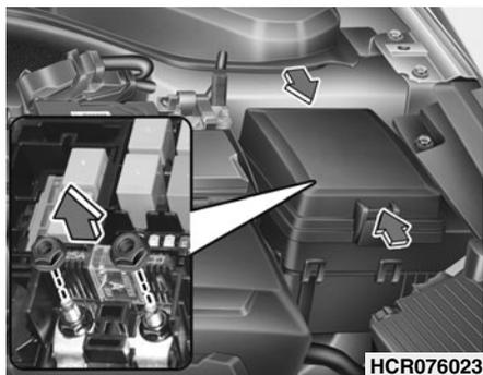
Перегоревший мультипредохранитель извлекают следующим образом:
