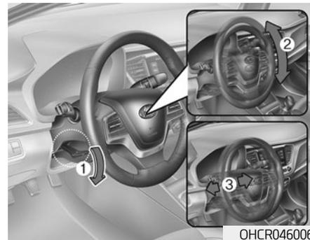
Потяните за рычаг блокировки (1) на рулевой колонке и отрегулируйте наклон (2) и положение рулевого колеса (3, при наличии). Рулевое колесо должно быть направлено в сторону грудной клетки, а не в лицо.
