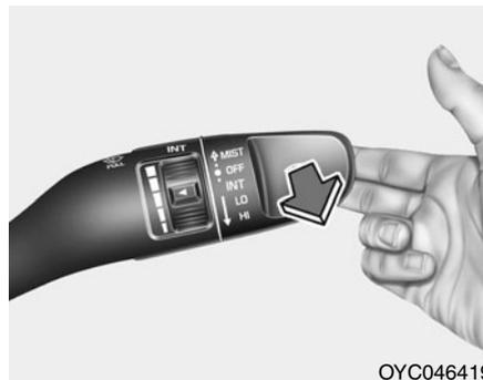
При нахождении рычага в положении OFF легко потяните его на себя для подачи жидкости на ветровое стекло и включения стеклоочистителей на 1–3 цикла работы. Работа стеклоомывателя и стеклоочистителя будет продолжаться до тех пор, пока вы не отпустите рычаг. Если стеклоомыватель не работает, возможно, необходимо пополнить количество моющей жидкости в бачке стеклоомывателя.
