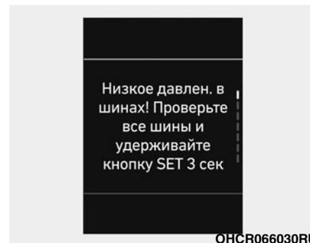
Когда включены предупреждающие индикаторы системы контроля давления в шинах, это означает, что в одной или нескольких шинах давление значительно ниже рекомендованного. Индикатор расположения шины с низким давлением указывает при помощи соответ-
