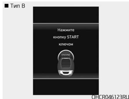
Это предупреждающее сообщение отображается, когда кнопка пуска/остановки двигателя нажата во время отображения предупреждающего сообщения «Ключ не обнаружен».
