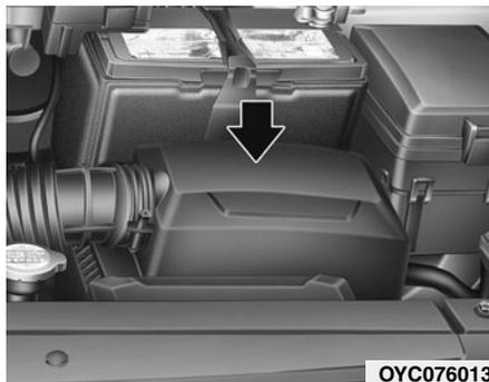
Воздушный фильтр для проверки можно очистить сжатым воздухом.
