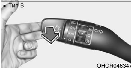
Для мигания дальним светом фар следует потянуть рычаг на себя и отпустить. Дальний свет остается включенным, пока не опущен рычаг.
