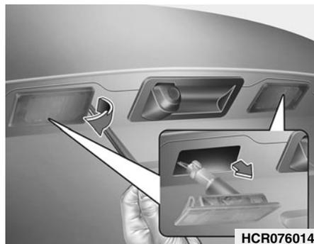
1. С помощью шлицевой отвертки аккуратно подденьте и извлеките рассеиватель из корпуса фонаря.
