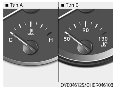
Этот прибор показывает температуру охлаждающей жидкости двигателя, когда выключатель зажигания находится в положении ОП.
