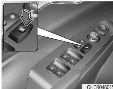
Водитель может заблокировать переключатели электростеклоподъемников задних дверей, нажав выключатель блокировки. Когда выключатель блокировки электростеклоподъемников находится в положении блокировки:
