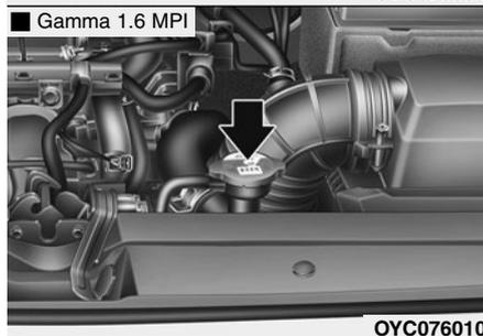
Проверьте состояние всех шлангов систем охлаждения и обогрева, а также их соединения. Замените все изношенные или имеющие вздутия шланги.
