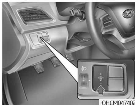
Когда на автомобиле включены габаритные огни или передние фары, используйте регулятор подсветки для изменения яркости подсветки приборной панели.
