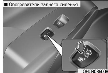
При работающем двигателе включите обогреватель сиденья водителя или пассажира.
