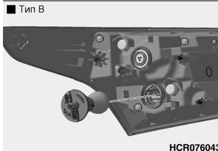
**Лампы стоп-сигналов, задних габаритных огней и указателей поворота**
