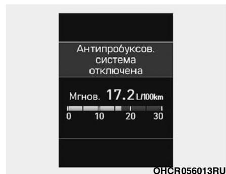
Кратковременно нажмите кнопку ESC OFF. Загорится индикатор ESC OFF и появится соответствующее сообщение (на автомобиле с дисплеем комбинации приборов). В этом состоянии функция контроля тягового усилия ESC (управление двигателем) деактивируется, но функция контроля тормозной системы ESC (управление торможением) остается активной.
