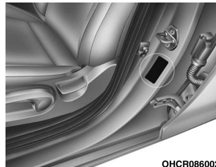
Сертификационная табличка автомобиля, закрепленная на средней стойке кузова со стороны водителя или переднего пассажира, также содержит идентификационный номер автомобиля (VIN).
