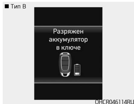
Это предупреждающее сообщение отображается во время выключения зажигания кнопкой пуска/остановки двигателя, когда разряжена батарея электронного ключа.
