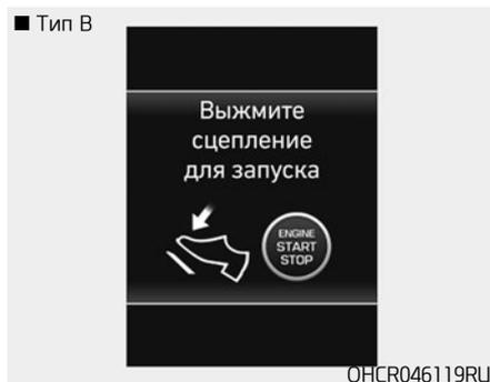
Это предупреждающее сообщение отображается, если кнопка пуска/остановки двигателя нажата в положение АСС дважды без нажатия педали сцепления.
