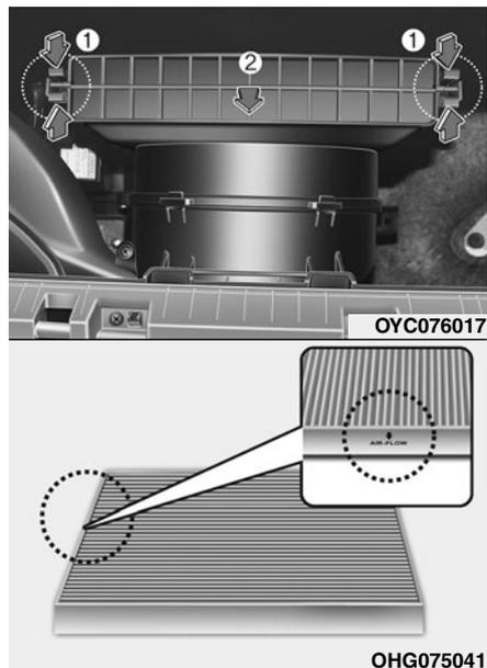
2. Снимите крышку воздушного фильтра системы управления микроклиматом при нажатии замка с обеих сторон крышки.
