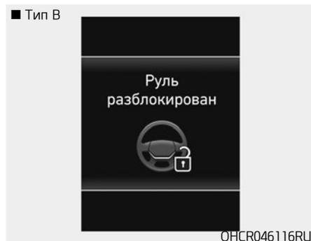
Это предупреждающее сообщение отображается, когда рулевое колесо не заблокировано при выключении зажигания нажатием кнопки пуска/остановки двигателя.
