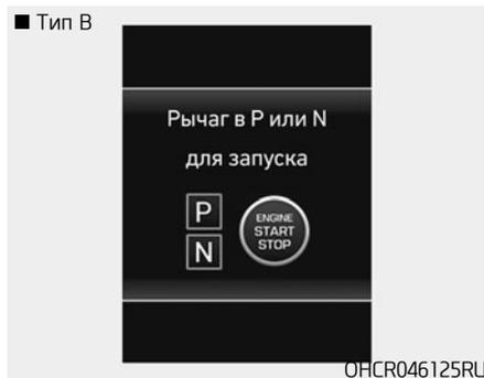
Это предупреждающее сообщение появляется при попытке пуска двигателя без установки рычага селектора в положение Р (парковка) или П (нейтраль).
