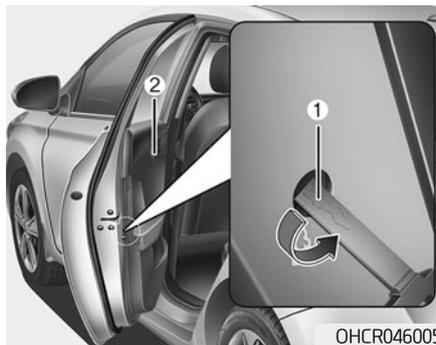
Устройство блокировки замков задних дверей предназначено для предотвращения их случайного открывания детьми, находящимися внутри автомобиля. Устройство блокировки замка для защиты детей должно использоваться всегда, когда в автомобиле находятся дети.
