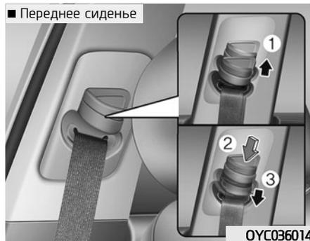
Для регулирования высоты крепления ремня безопасности следует сместить регулятор высоты в требуемое положение.
