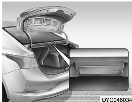
Лампа освещения багажника включается при открытой крышке багажника.
