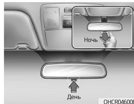
Регулировку положения зеркала заднего вида необходимо производить перед началом движения, когда рычажок переключения дневного/ночного режима находится в положении дневного режима.
