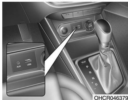
Для подключения портативных аудиоустройств могут использоваться разъемы AUX, USB или iPod®.
