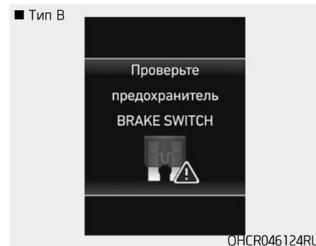
Это предупреждающее сообщение появляется в случае отключения предохранителя выключателя тормоза.
