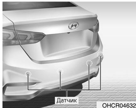
Системой помощи при парковке задним ходом подается звуковой сигнал при обнаружении какого-либо объекта на расстоянии до 120 см (50 дюймов) позади автомобиля.
