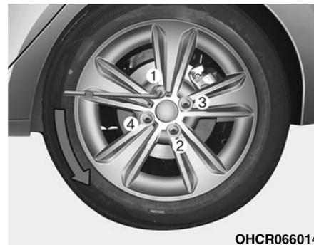
6. Ослабьте против часовой стрелки гайки крепления колеса, но не откручивайте их полностью, пока колесо не будет поднято над землей.
