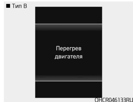
Это предупреждающее сообщение отображается, когда температура охлаждающей жидкости двигателя превышает 120°C (248°F). Это означает, что двигатель перегрелся и возможно его повреждение.
