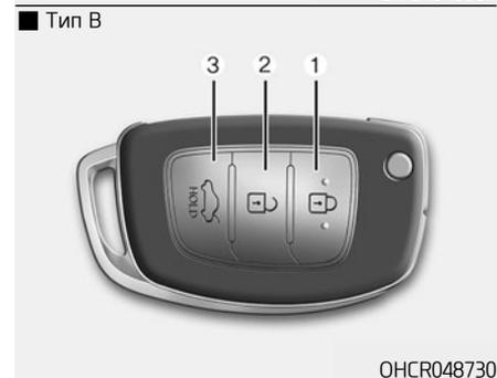
Для блокирования дверей нажмите кнопку блокирования дверей (1) на дистанционном ключе.
