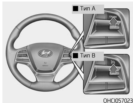
1. Для включения СИСТЕМЫ нажмите кнопку CRUISE /
